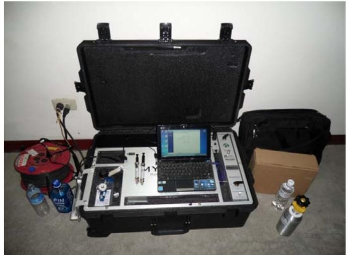
圖一、移動式氣體分析儀（這套氣體分析儀具有可移動至現場又有與實驗室相當的分析精度,可以提供現場取樣分析）
